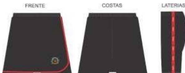
Confeccionada como tecido principal em helanca 100% poliéster com tolerância de variação de 3% +/-, gramatura de 260 gr/m<sup>2</sup> com tolerância de variação de 5% +/-, cor Preto Pantone 19-3911 TPX.
