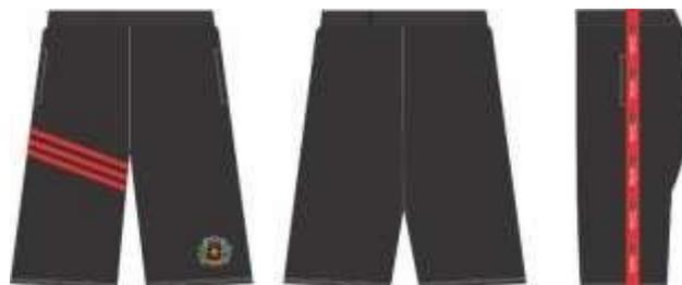
Confeccionada como tecido principal em helanca 100% poliéster com tolerância de variação de 3% +/-, gramatura de 260 gr/m<sup>2</sup> com tolerância de variação de 5% +/-, cor Preto Pantone 19-3911 TPX.
