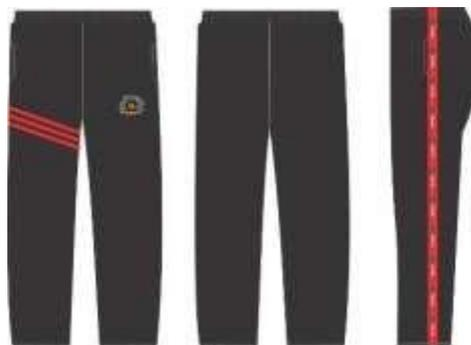
Confeccionada como tecido principal em helanca 100% poliéster com tolerância de variação de 3% +/-, gramatura de 260 gr/m<sup>2</sup> com tolerância de variação de 5% +/-, cor Preto Pantone 19-3911 TPX.
