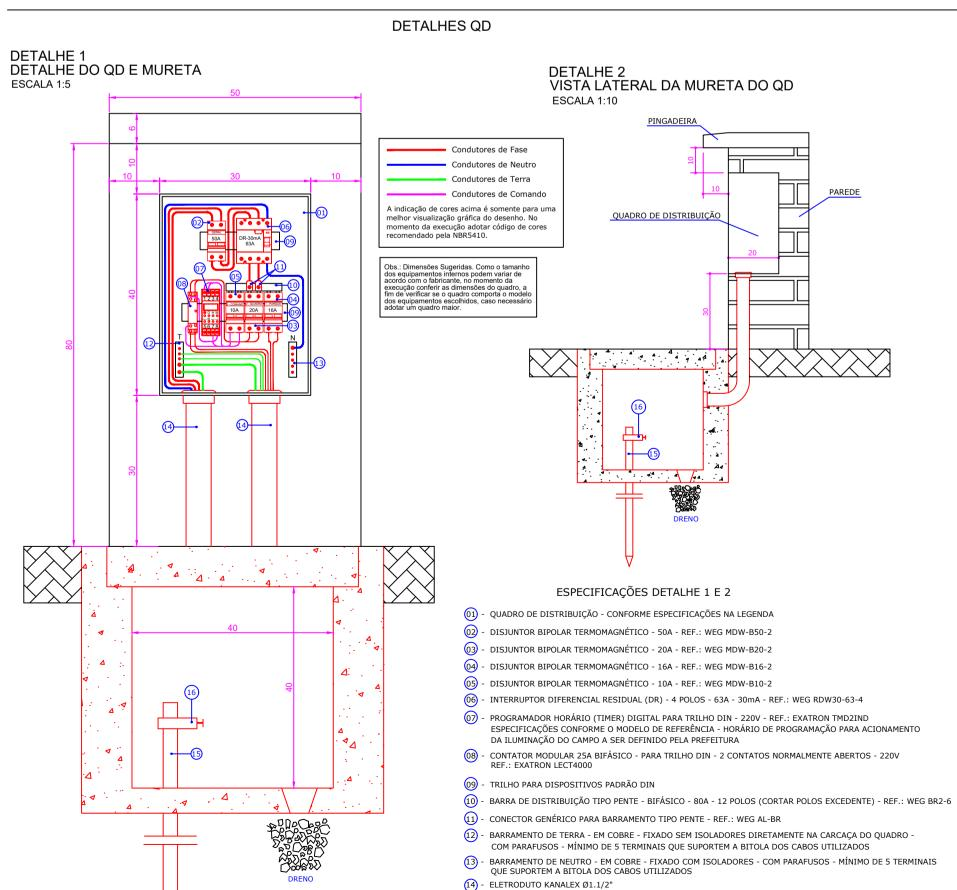
(is) - HASTE DE ATERRAMENTO TIPO COPPERWELD Ø5/8 x 2,40m ALTA CAMADA 254 MICRONS - REF.: TEL 5814
