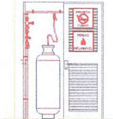
Det. 9 Detalhe 9 - CORTE CASA GÁS S/ESCALA
