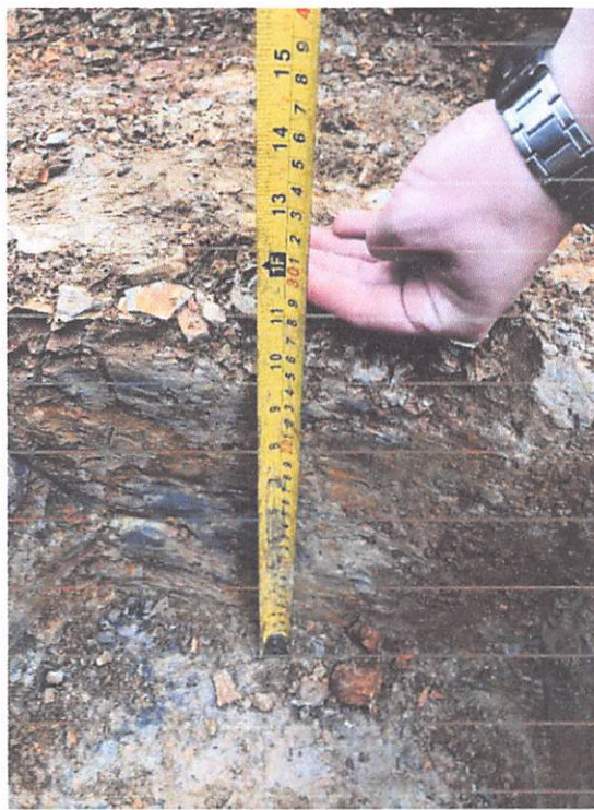
Figura 3 - Conferência da profundidade da cava menor.
